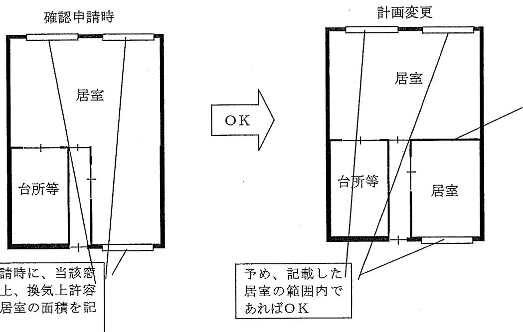
事例2：間取りの変更において、各部にかかる固定荷重又は積載荷重が増加しない場合（採光・換気に関しては変更がない。）
