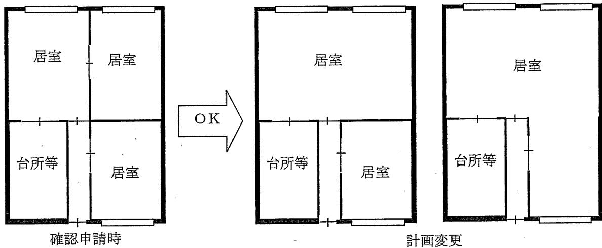
事例3：間取りの変更において、各部にかかる固定荷重又は積載荷重が増加しない場合（採光・換気に関しては予め検討し、申請することにより処理）
